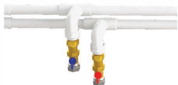
Трубы подводводы изготовлены из ПВХ
